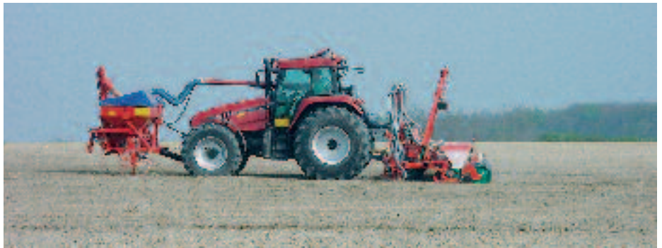
Lohnunternehmer Göcke sät mit dem 16-reihigen Einzelkornsäegerät der Firma Kverneland-Accord. Um die Schlepperhinterachse und den Boden zu schonen, ist der Tank für den Unterfußdünger in der Fronthydraulik angebracht
